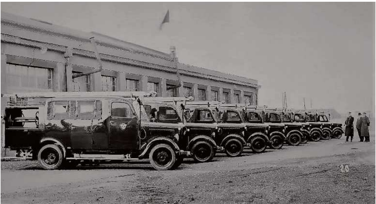
„Schnell“ LF in Luckenwalde vor der Auslieferung mit heruntergelassenem seitlichem Segeltuch-Vorhang hinter dem Fahrer- und Führerplatz.
