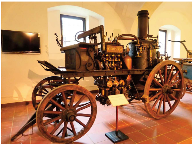
Abbildung 8: Durchlaufende Räder an einer Dampfspritze (Foto: Greulich)
