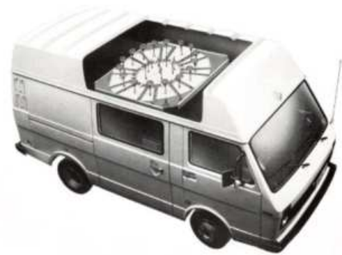
Stat 1: Peilfahrzeug mit tankbarer VHF/UHF-Polarantenne AK 1206 VU
