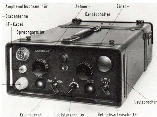
Funkanlage SEL SEM 16-80 / FuG 8
