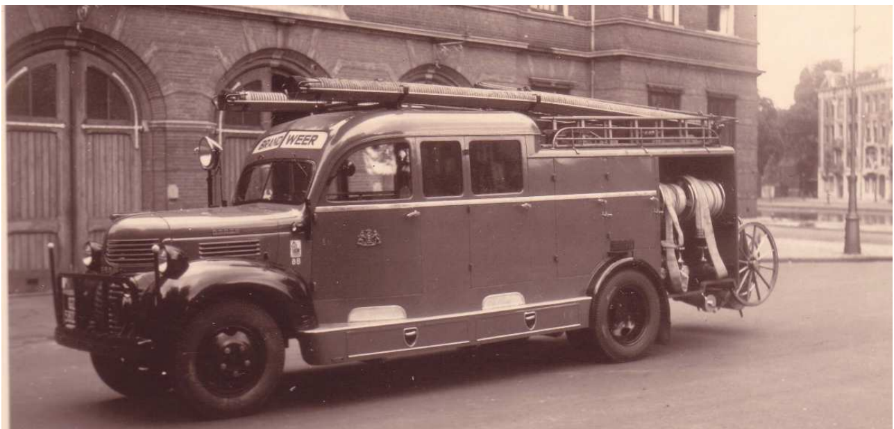
Ab 1946 bis 1972 wurden bei der Berufsfeuerwehr Amsterdam Löschfahrzeuge auf Dodge Fahrgestelle benutzt, dessen Aufbauten basierten auf die Magirus KS25. Dies zeigt der Dodge Baujahr 1947 der Wache Honthorststraat in Amsterdam. (Foto: Brandweer Amsterdam)
