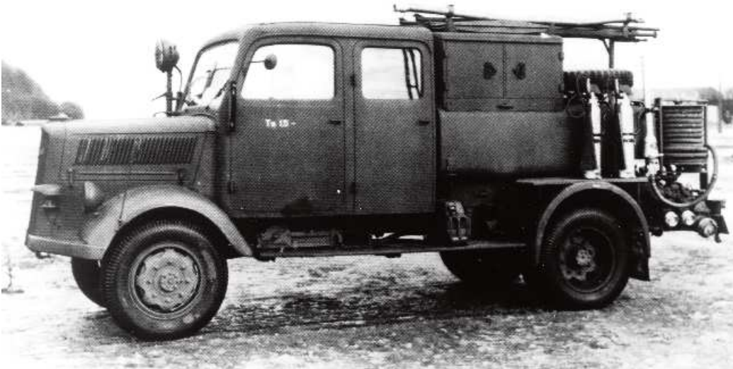
Für kleinere Einheiten der Luftwaffe oder Fliegerhorste in Waldgebieten wurde ein kleines Tanklöschfahrzeug entwickelt mit kleineren Löschwasserbehältern und separat arbeitender Pumpe. Bis heute ist dieses System noch sehr beliebt in den französischen Waldgebieten. Foto: Sammlung Karl Rode
