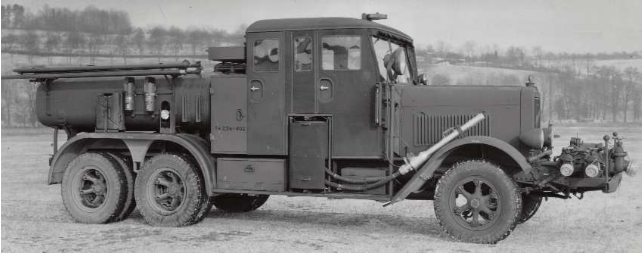
Vom genormten deutschen Flughafenlöschfahrzeug haben zusammen um die 900 bei der Luftwaffe gedient. Auch Schiphol verfügte über einen und während den „Zeiten mit viel Beschäftigung“ möglicherweise auch zwei Stück. Mit Löschwassertank, Schaummittel-tank und Pumpe konnte über die bereitliegenden Schläuche mit Schaumstrahlrohre innerhalb von Sekunden nach Ankunft an der Unfallstelle mit Schaum die Löschung angefangen werden. Foto: Sammlung Karl Rode
