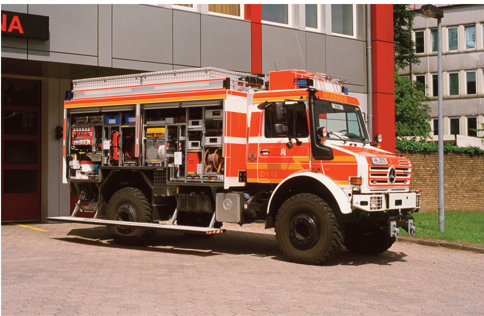
Für größere technische Hilfeleistungen werden seit 2012 vier Rüstwagen Typ GW-R2 auf MB Unimog 5000 mit Aufbau von Ziegler beschafft.
