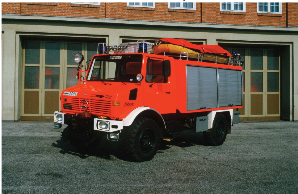
Rüstwagen RW 1 der 2. Generation: MB Unimog U 1300 L, Aufbau Metz. Beschaffungen von 1983 bis 1987: 17 Stück.
