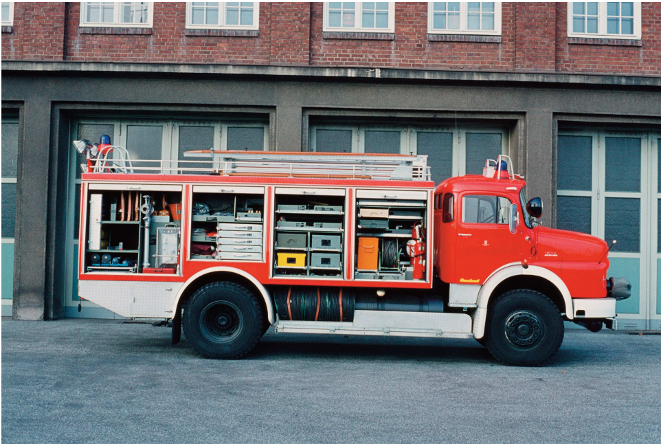
Rechts einer der zwei Rüstwagen RW 2 auf Kurzhauber-Fahrgestell MB LAF 1113 B mit Aufbau von Metz (Baujahr 1971, links der Rüstwagen RW-Öl auf Kurzhauber-Fahrgestell MB LA 1313 mit Aufbau von Ziegler (Baujahr 1971).
