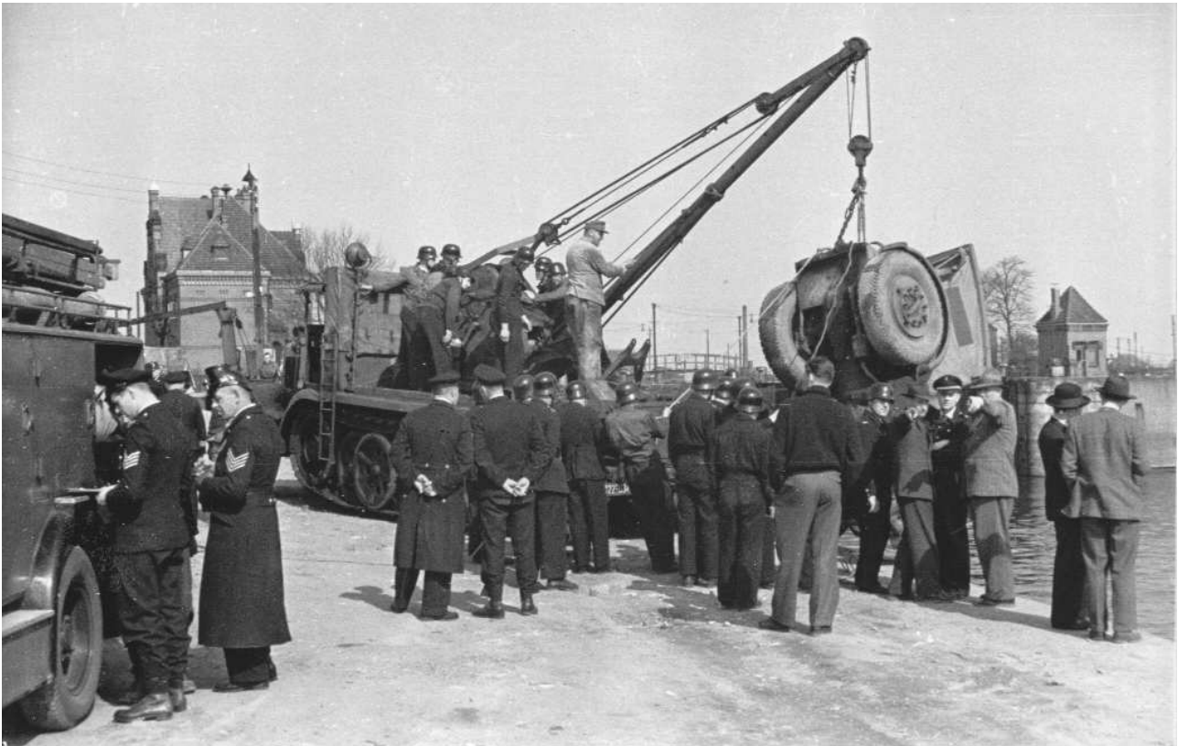
Als Behelfskranwagen KW 6 nutzte die BF Hamburg von 1947 bis 1958 diesen Halbketten-Zugkraftwagen Zgkw 18 (Geschützschiefler) der ehemaligen Wehrmacht, Baujahr 1947. Hier im Einsatz bei Bergung eines verunfallten Lkw.
