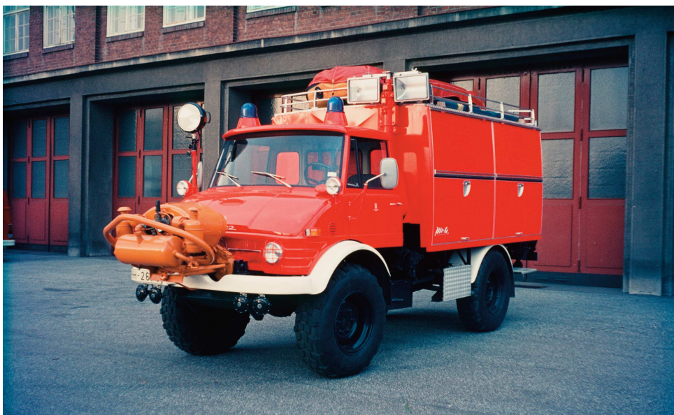
Rüstwagen RW 1 der 1. Generation: MB Unimog U 125, Aufbau Metz. Beschaffungen von 1972 bis 1974: 16 Stück.
