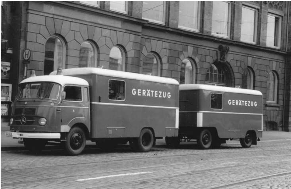
Der "Gerätezug" von 1963 als Nachfolger des Werkstattzuges basierte auf einem Mercedes-Benz -Kastenwagen LPF 311 (Pullman) mit einem Anhänger. Der Gerätezug blieb bis 1977 im Dienst.
