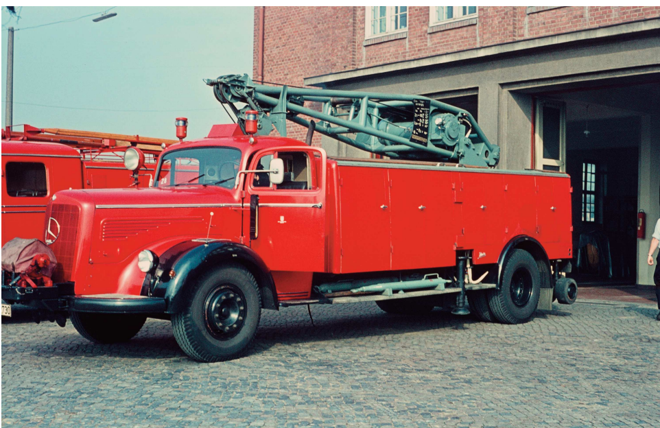
Erster Rüstkraftwagen der Nachkriegszeit: RKW 10 Metz auf MB L 6600. Im Dienst von 1953 bis 1971.
