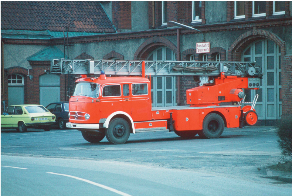
Metz-DL 30 h (h=hydraulisch) auf "Pullman"-Fahrgestell Mercedes-Benz LP 329. 1958 wurde die erste Drehleiter der Nachkriegszeit beschafft. Bis 1965 wurden insgesamt 18 Stück angeschafft. Besonderes Merkmal: 3-t-Kraneinrichtung.
