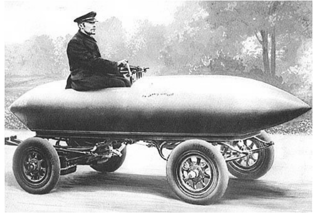
Emille Jenatzy mit seinem elektrischen Rekordwagen. Er war der Erste, der 100km/h schnell war.
