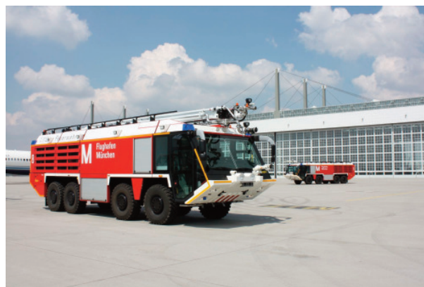
Abb. 17: Auf dem MAN SX-Chassis mit 1000 PS sind viele Flugfeldlöschfahrzeuge entstanden, so auch für den Flughafen München.
