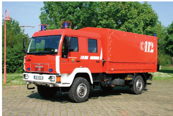
Abb. 18: Speziell gebaute Serie: 371 GW-Dekon P auf der L90-Baureihe mit serienmäßiger Doppelkabine.
