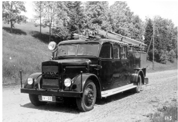
Abb. 4: Vermutlich den Prototypen einer KS 15 auf MAN Z1 mit Koebe-Aufbau von 1934 zeigt dieses Foto
