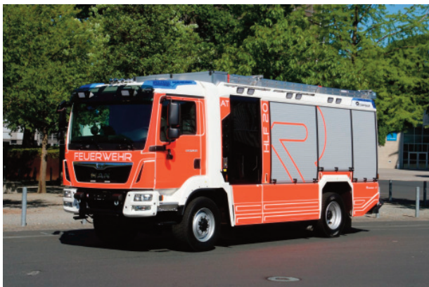
Abb. 16: Neu ist die Euro 6-Ausführung der MAN TGM-Baureihe. Hier ein HLF 20 auf TGM 13.290 4x4 BL-FW.
