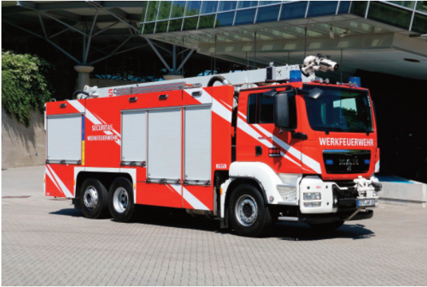
Abb. 14: Exponat auf der Interschutz 2015: Auf einem MAN TGS 26.440 realisierte Empl ein SLF 60/20+500P mit Löscharm.
