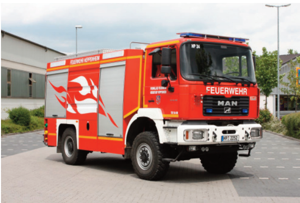
Abb. 12: Dieser MAN FE 19.310 läuft seit 2004 bei der FF Heppenheim-Mitte. Der Aufbau des TLF 24/50 stammt von Empl.
