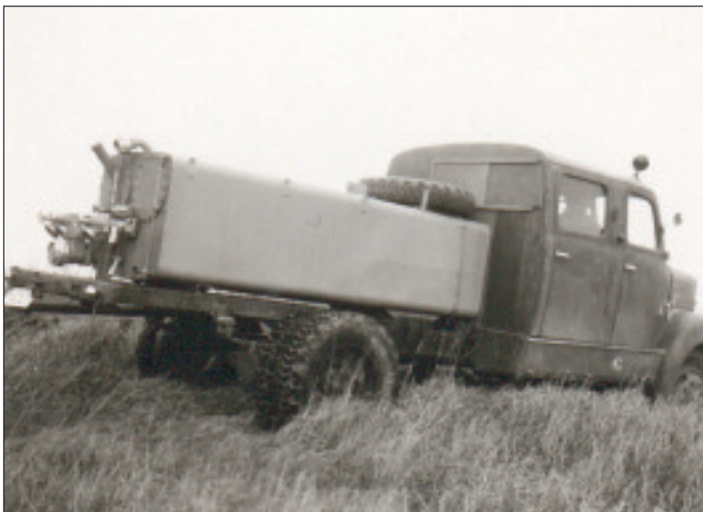
Aufbau ohne Verkleidung auf Geländefahrt: die Pumpe sitzt im Rahmen unterhalb des Mannschaftsraums
